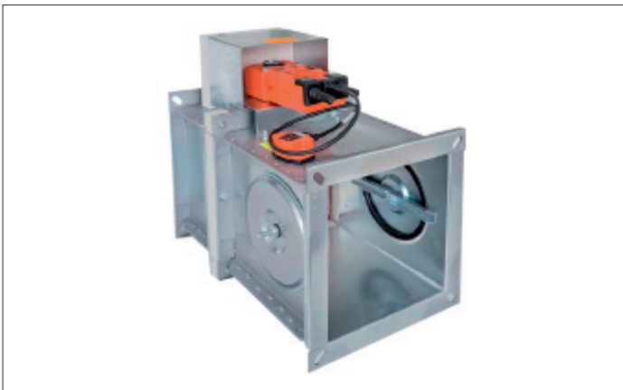
1. ábra Szögletes FDMA - működtető mechanizmussal rendelkező kialakítás
